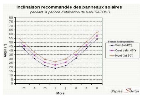
Pour des raisons de tirant d'air et peut-être aussi d'esthétique, il n'est pas possible de suivre cette recommandation. Au solstice d'hiver, cela réduit de moitié l'énergie reçue par les panneaux. Pendant les 2<sup>ème</sup> et 3<sup>ème</sup> trimestres, l'angle recommandé est plus proche de l'horizontale, 25° en moyenne en Languedoc-Roussillon.
